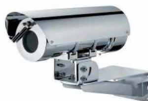
Dans la version avec essuie-glace, MHX est équipé d'un récepteur de télémétrie intégré qui permet, par l'intermédiaire de l'interface série RS-485, de recevoir des données à distance pour l'activation de l'essuie-glace / lave-glace et pour l'allumage d'un éventuel projecteur externe.
